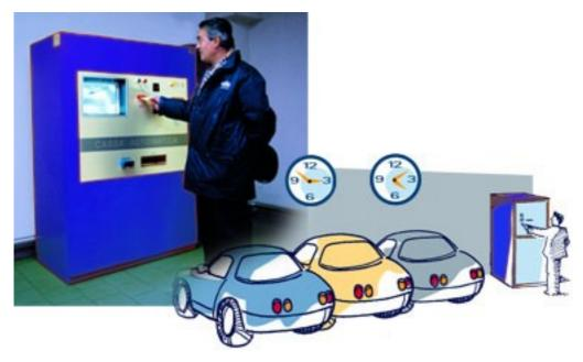
Al termine del periodo di sosta, l'utente rientra nel parcheggio. Prima di ritirare la propria vettura, si presenta alla **Cassa Automatica di Pagamento** la quale si incarica di conteggiare l'orario di permanenza della vettura nel parcheggio in base alle tariffe in vigore ed alle specifiche fasce orarie reimpostate dal gestore.
