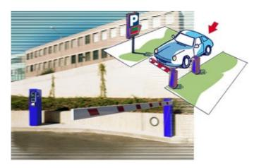
La **Pista di Entrata** è costituita da una **Colonnina di Emissione** presso la quale l'utente si avvicina e, t6ramite apposito pulsante di richiesta, riceve un biglietto in carta termica sul quale vengono memorizzati i dati di ingresso (data – ora - identificativo terminale, ecc) sotto forma di codice a barre.
